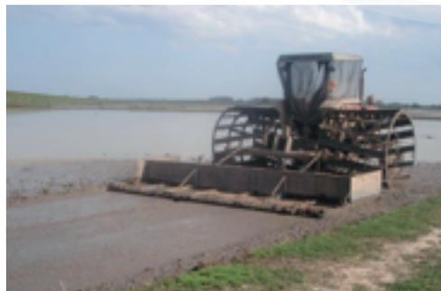
Nivelación mecanizada en lámina de agua.
