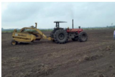
Nivelación mecanizada en suelo seco.
