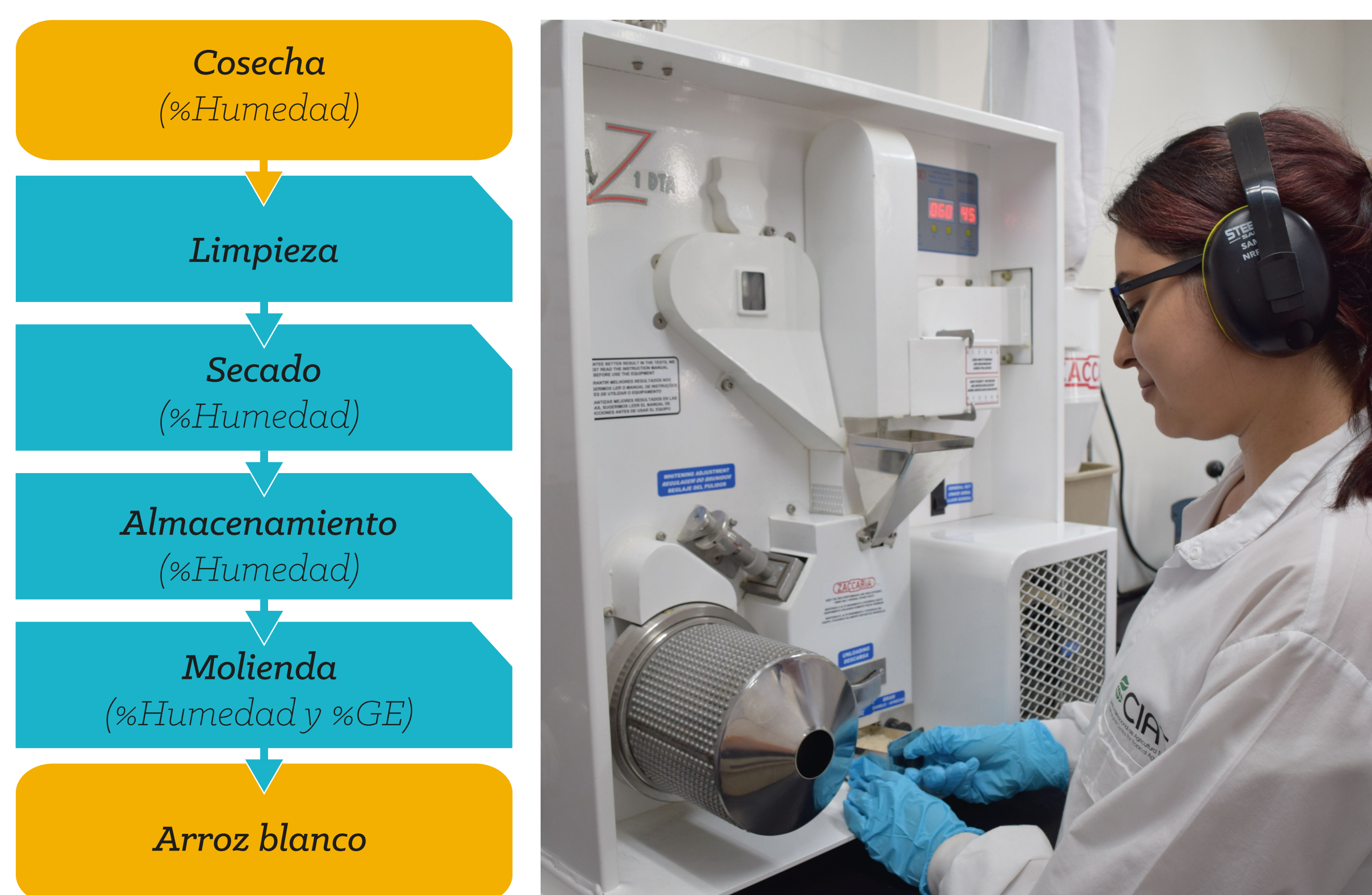
Figura 1. Etapas de poscosecha y obtención de arroz blanco en el molino Zaccaria PAZ-1 DTA.
